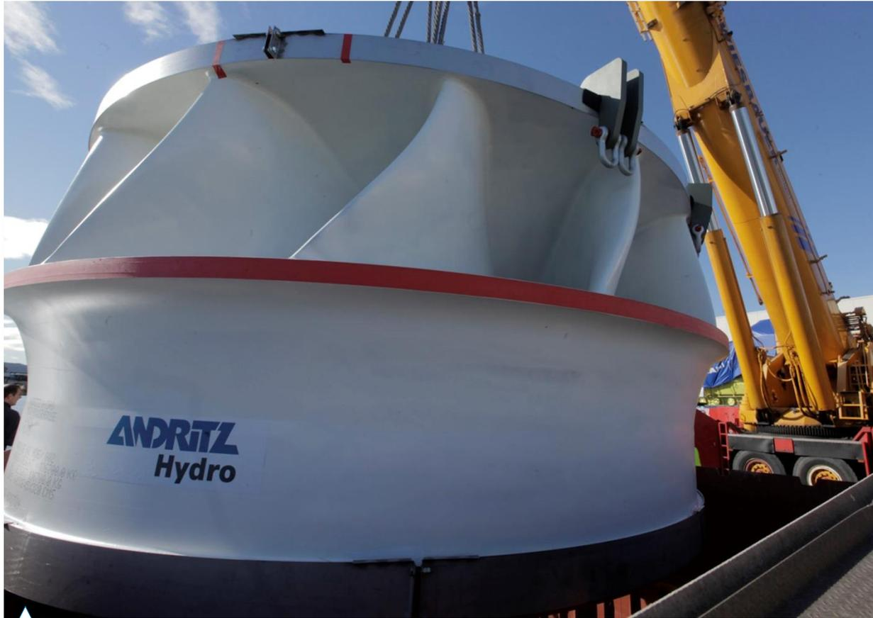
ANDRITZ liefert zwei Francisturbinen für das Wasserkraftwerk Mica in British Columbia, Kanada. Jede Turbine verfügt über eine Leistung von 520 Megawatt und misst im Durchmesser 5,6 Meter
