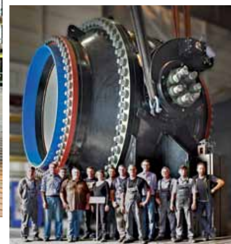
▲ Шаровой затвор для ГЭС «Herdecke»: завершение испытания на герметичность после обслуживания
